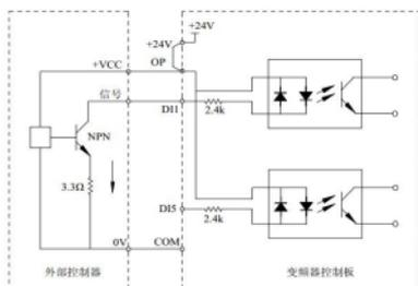
图 3-26 漏型接线方式
