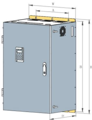
图 6-2 580 系列 钣金结构外型尺寸及安装尺寸示意图
