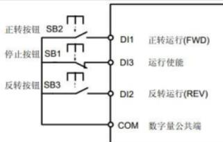
如上图所示, 该控制模式在 SB1 按钮闭合状态下, 按下 SB2 按钮变频器运行, K 断开变频器正转, K 闭合变频器反转; SB1 按钮断开瞬间变频器停机。正常启动和运行中, 必需保持 SB1 按钮闭合状态, SB2 按钮的命令则在闭合动作沿即生效。
