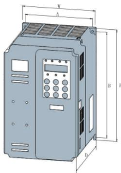
图 6-1 580 系列 塑胶结构外型尺寸及安装尺寸示意图
