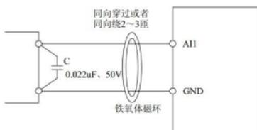
图 3-25 模拟量输入端子处理接线图
