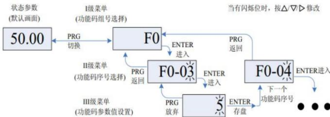
图 4-2 三级菜单操作流程图
