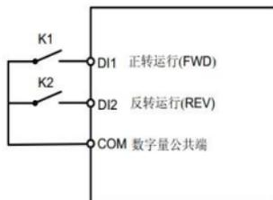
如上图所示，该控制模式下，K1 闭合，变频器正转运行。K2 闭合反转，K1、K2 同时闭合或者断开，变频器停止运转。
