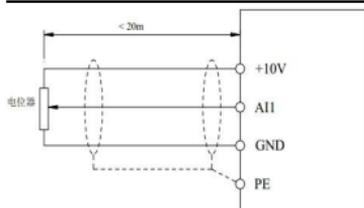
图 3-24 模拟量输入端子接线示意图
