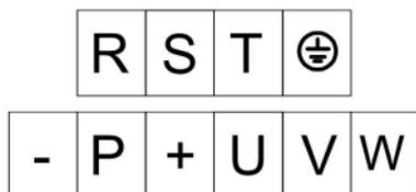
图 3-17 110kW-400kW 主回路接线端子 (上面进线, 下面出线)
