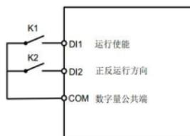
如上图所示，该控制模式在 K1 闭合状态下，K2 断开变频器正转，K2 闭合变频器反转；K1 断开，变频器停止运转。
