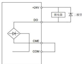
图 3-29 数字输出端子接线示意图
