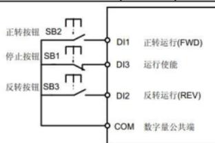
如上图所示, 该控制模式在 SB1 按钮闭合状态下, 按下 SB2 按钮变频器正转, 按下 SB3 按钮变频器反转, SB1 按钮断开瞬间变频器停机。正常启动和运行中, 必需保持 SB1 按钮闭合状态, SB2、SB3 按钮的命令则在闭合动作沿即生效, 变频器的运行状态以该 3 个按钮最后的按键动作为准。
