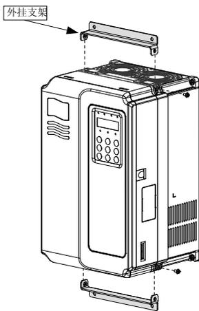
图 3-4 塑胶结构安装外挂支架示意图
