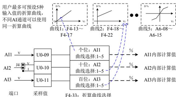
图 4-21 AI 信号对应实际给定
