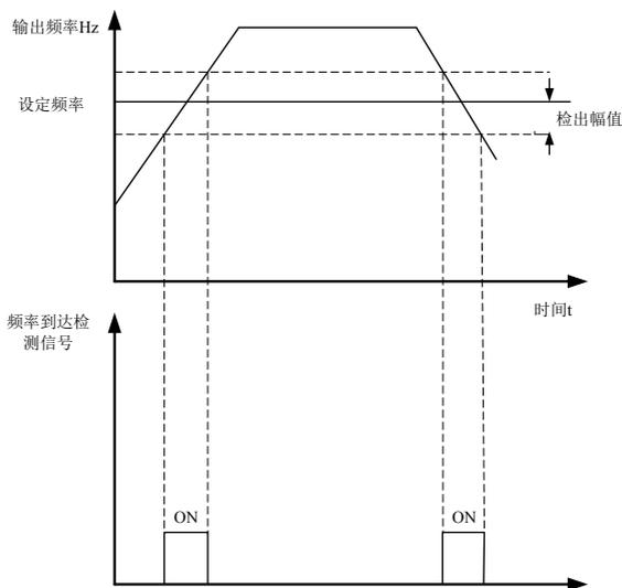
图 6-19 频率到达检出幅值示意图
