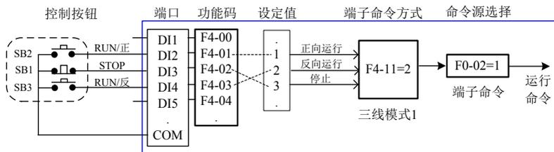
图 4-6 端子启停控制方式举例
