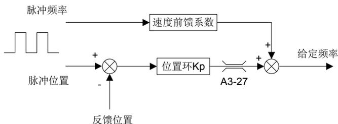
图 6-30 脉冲定位时给定频率限幅
