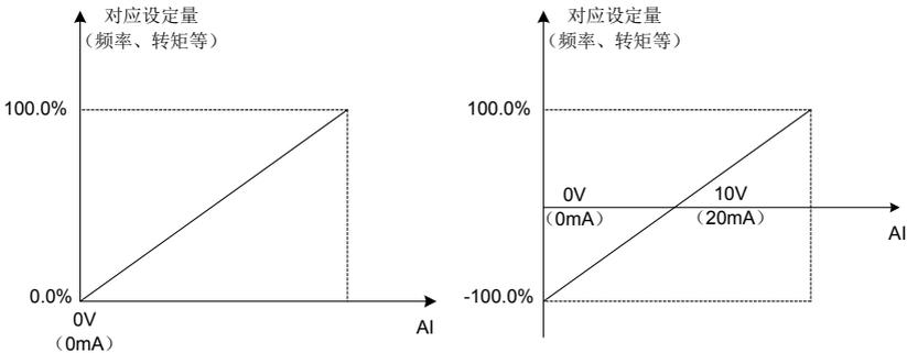
图 6-14 模拟给定与设定量的对应关系
