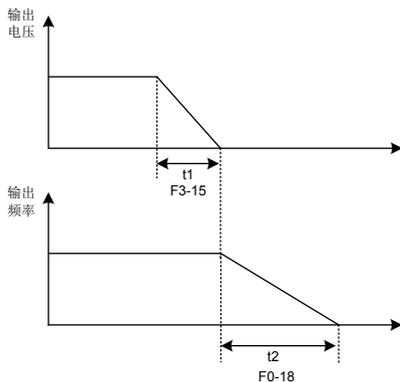
图 6-6 V/F 分离频率 / 电压先后下降示意图
