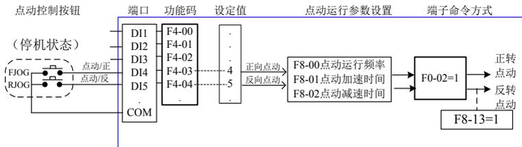
图 4-11 通过 DI 端口点动运行
