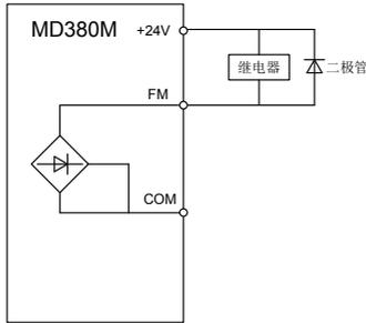
图 3-22 数字输出端子接线示意图
