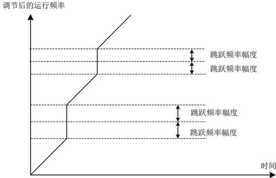
图 6-20 加减速过程中跳跃频率有效示意图
