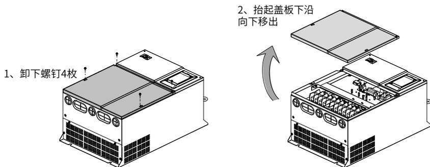
图 3-13 钣金外壳下盖板拆卸图
