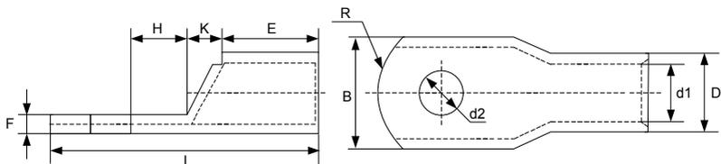
图 8-12 GTNR 系列线耳尺寸图
