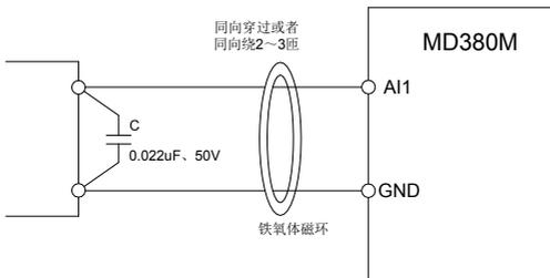
图 3-18 模拟量输入端子处理接线图
