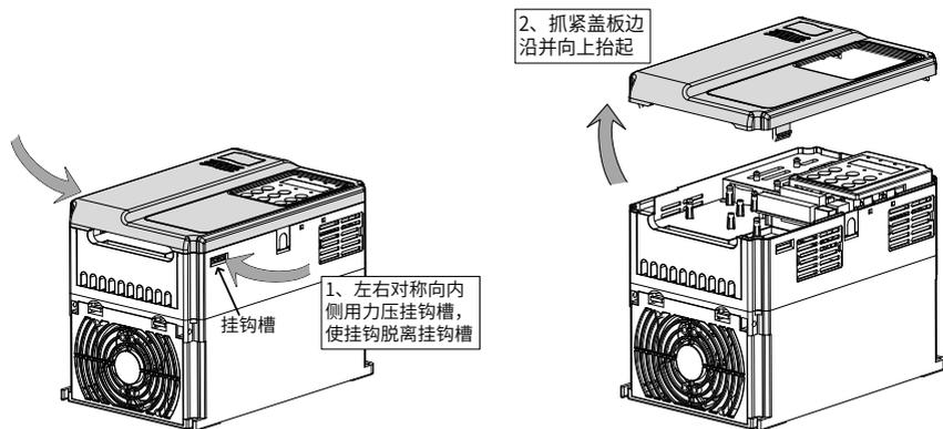
图 3-12 塑胶外壳盖板拆卸图 (MD380M)
