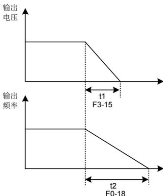
图 6-5 V/F 分离输出电压 / 频率独立减至 0
