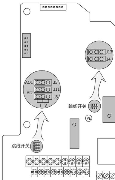
图 3-15 跳线开关分布示意图
