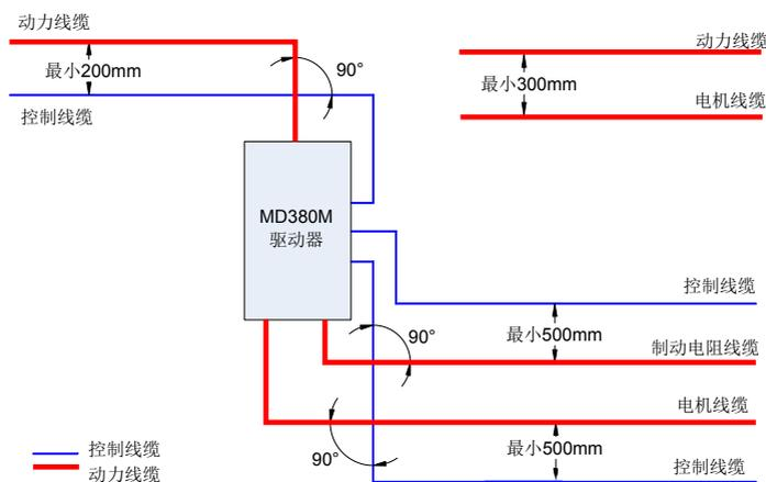
图 7-5 电缆布线图
