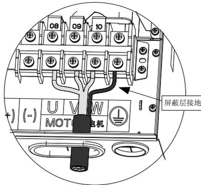
图 7-4 屏蔽电缆接地示意图
