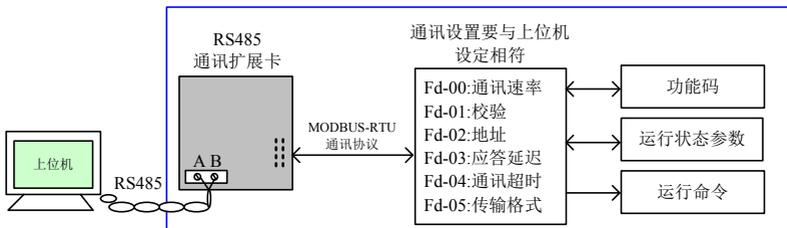
图 4-23 主轴伺服驱动器串行通讯的使用
