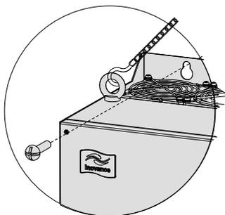
图 3-8 钣金结构吊装示意图
