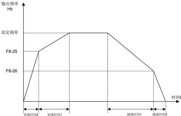
图 6-21 加减速时间切换示意图
