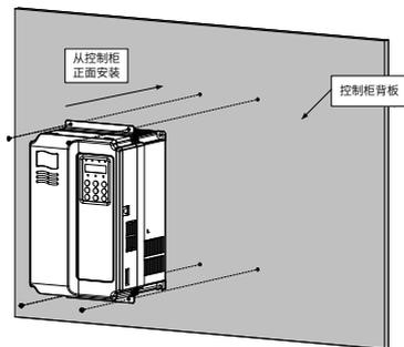
图 3-3 塑胶结构壁挂式安装示意图
