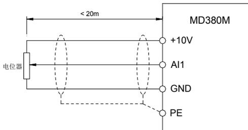
图 3-17 模拟量输入端子接线示意图
