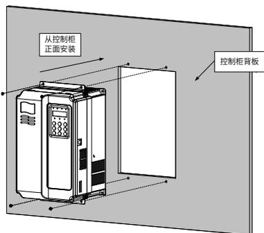
图 3-5 塑胶结构嵌入式安装示意图
