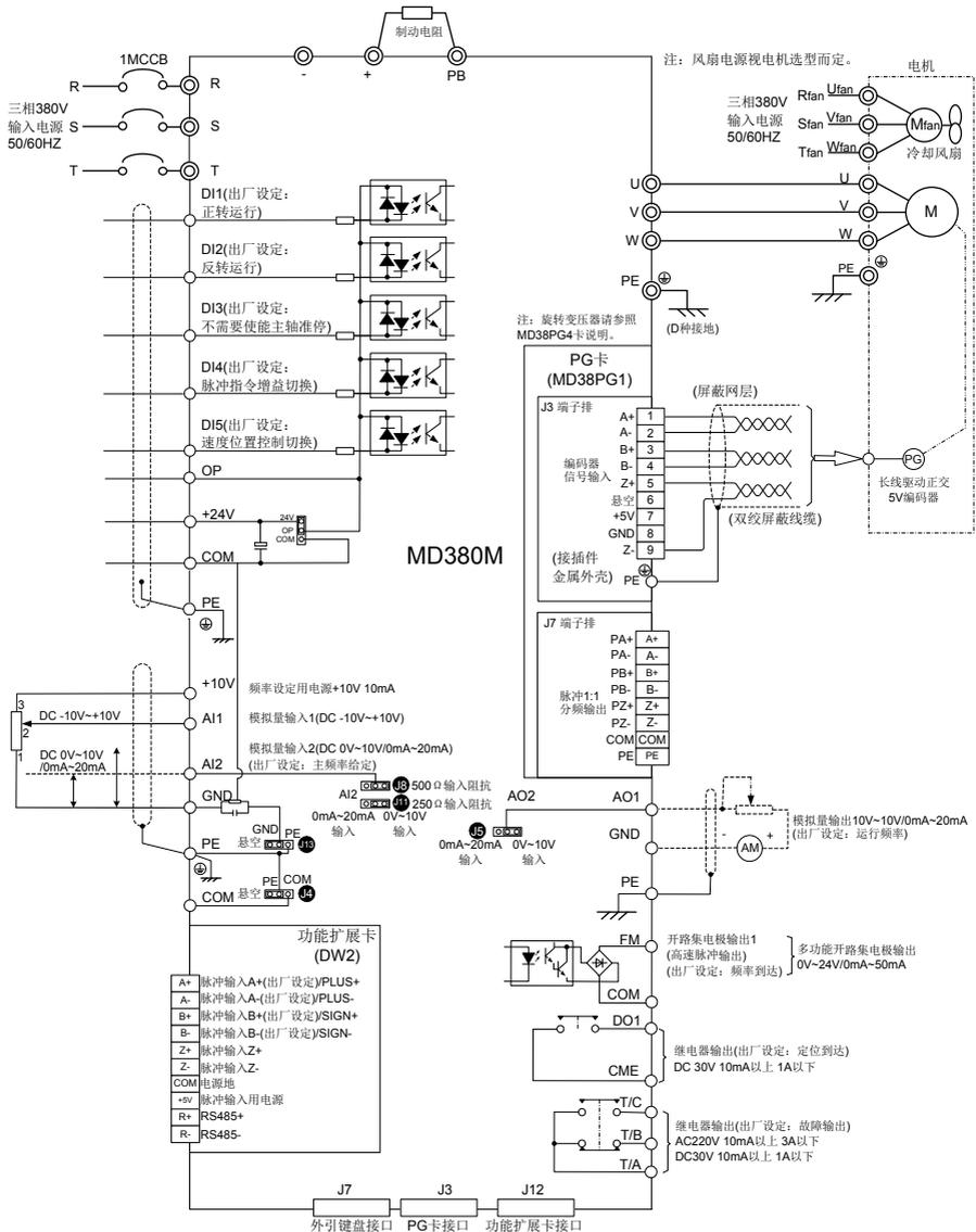
图 3-16 主轴伺服驱动器控制回路接线方式
