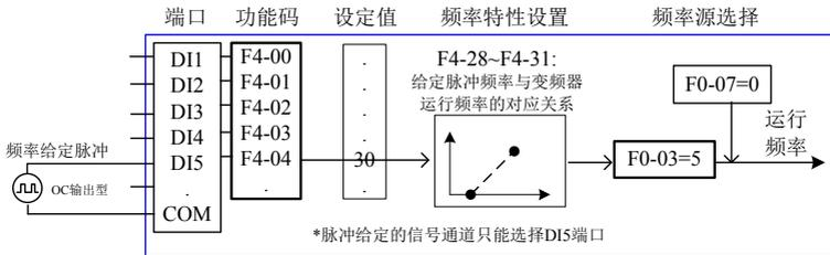
图 4-17 脉冲给定频率功能码设置
