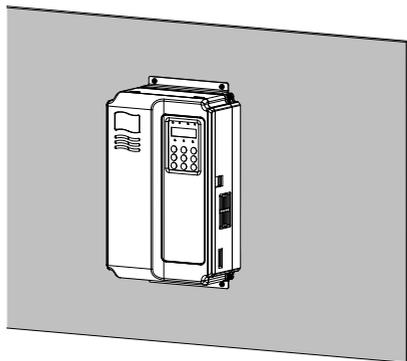
图 3-6 塑胶结构嵌入式安装效果图
