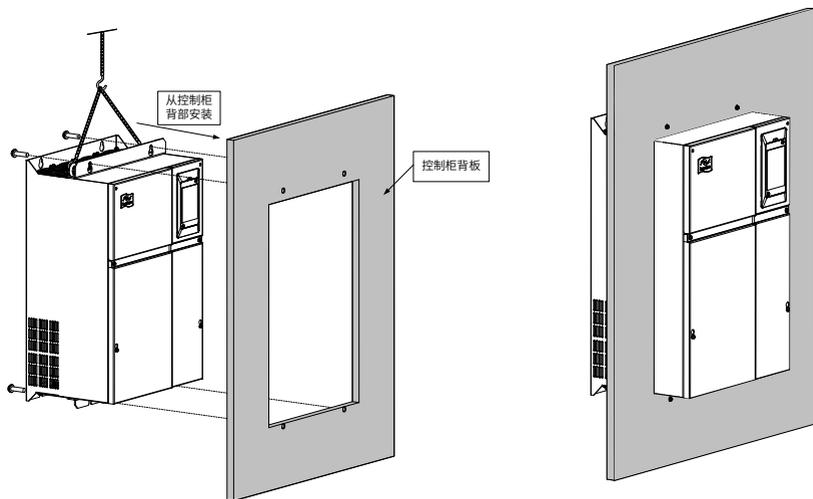
图 3-10 塑胶结构嵌入式安装示意图
