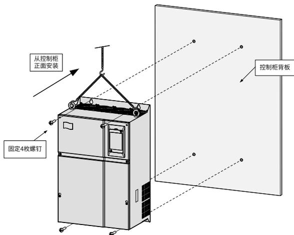
图 3-7 钣金结构壁挂式安装示意图
