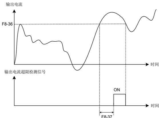
图 6-24 输出电流超限检测示意图
