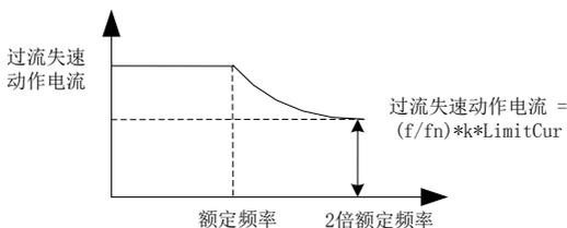
图 6-8 倍速过流失速动作示意图
