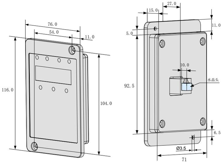
图 8-14 外引键盘的外型尺寸 (单位: mm)
