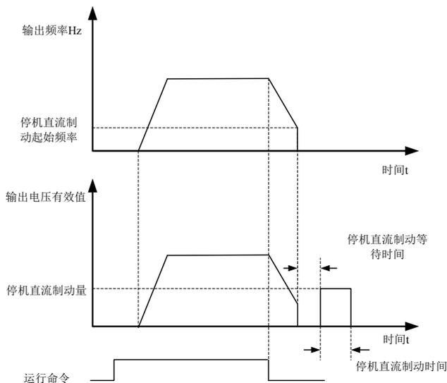
图 6-15 停机直流制动示意图
