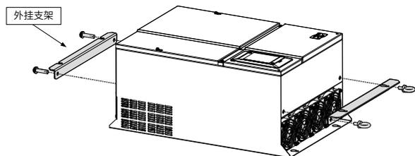
图 3-9 钣金结构安装外挂支架示意图
