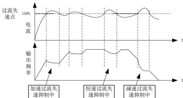
图 6-7 过流失速动作示意图
