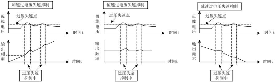
图 6-9 过压失速动作示意图
