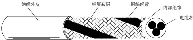
图 7-3 屏蔽电缆编织密度示意图
