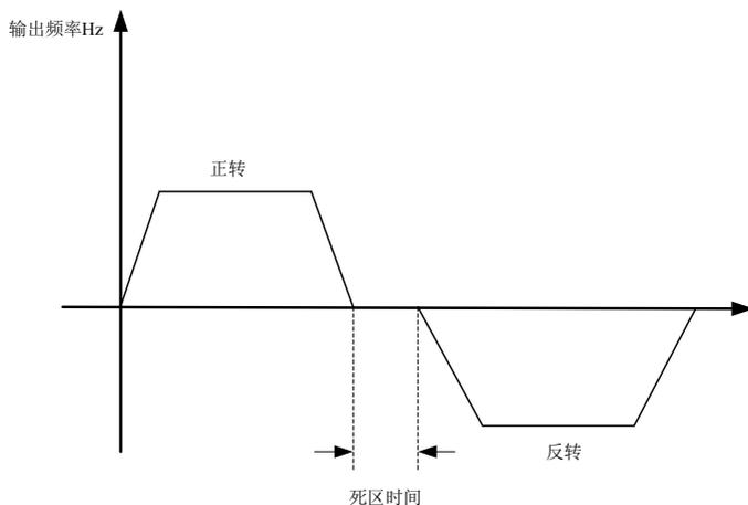
图 6-17 正反转死区时间示意图
